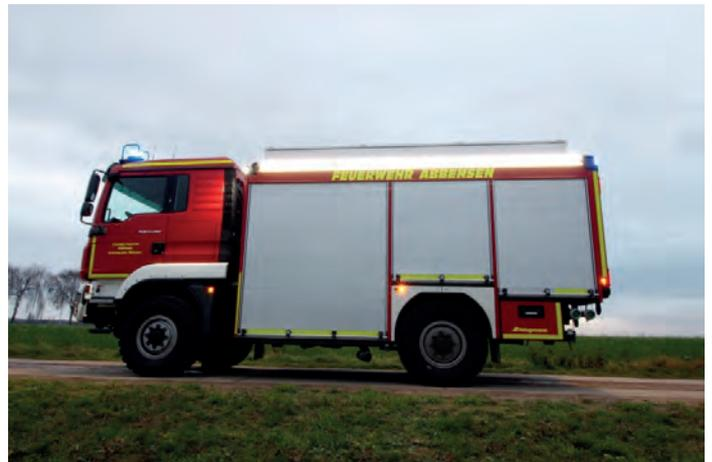
Besonders am neuen Fahrzeug ist die Zusatzbeladung für Wald- und Vegetationsbrandbekämpfung. Bei langsamer Fahrt kann aus der Dachluke über ein handgeführtes Strahlrohr Wasser abgegeben werden. Das Fahrzeug verfügt über einen Wasserwerfer, der zusätzlich mit einem Schaumrohr betrieben werden kann. Der Wasserwerfer befindet sich auf dem Dach, kann aber je nach Lage des Brandes abmontiert und am Boden verwendet werden.
